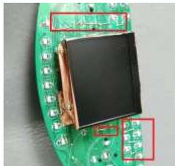
b、组合仪表中液晶显示屏干扰较大，因此将液晶显示屏外框与金属搭接良好，并将液晶显示屏 PCB 用铜箔进行屏蔽，与 PCB 板地连接；
