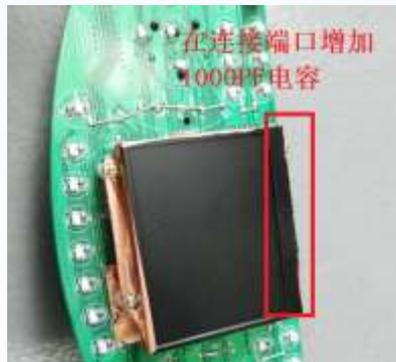
d、组合仪表主板干扰较大，将主板电路部分进行屏蔽处理；
