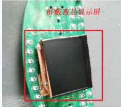
c、由于液晶显示屏与主板连接端口干扰较大，故在连接端的信号线上增加 1000PF 对地电容进行滤波；
