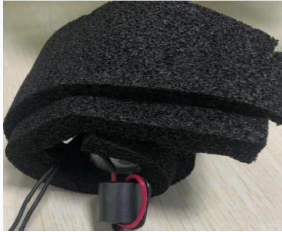
图（9）负压泵电源线加磁环
