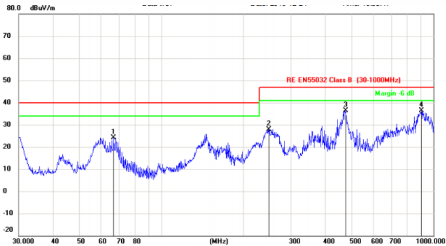
图（12）整改后 RE 水平方向数据
